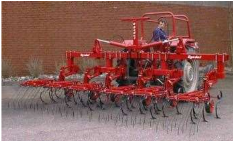
Version 3 rangs – 4 éléments – repliable par vérins hydrauliques
