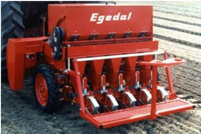
Le semoir Type Combi *d'Egedal* est utilisable pour semer la quasi-totalité des semences utilisées en pépinières. La trémie a une capacité d'environ 280 litres, elle est conçue pour se vider en totalité.
