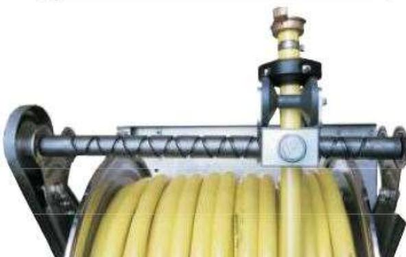
Guide d'enroulement par vis sans fin
