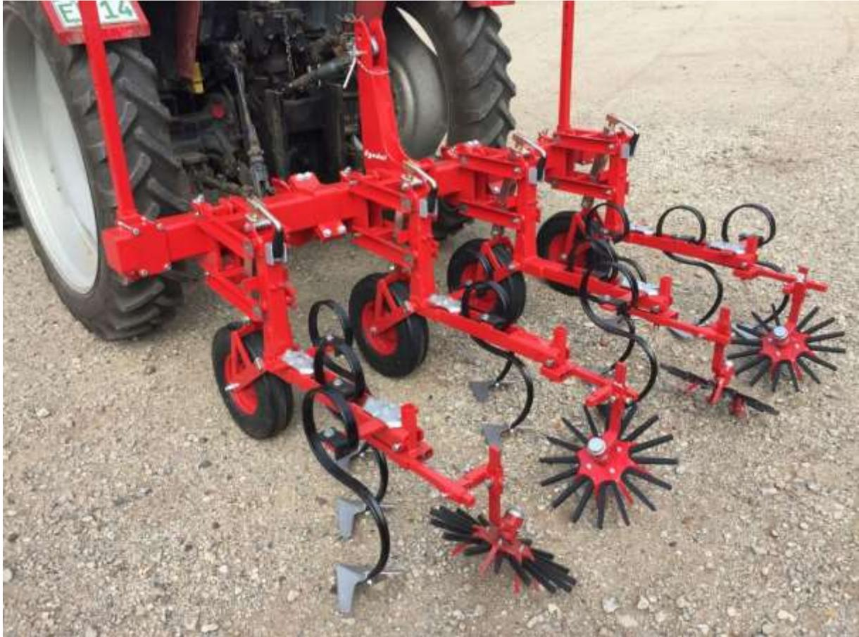
Groupe de binage monté sur parallélogramme avec grande roue, réglage fin de la profondeur par manivelle avec système de verrouillage
