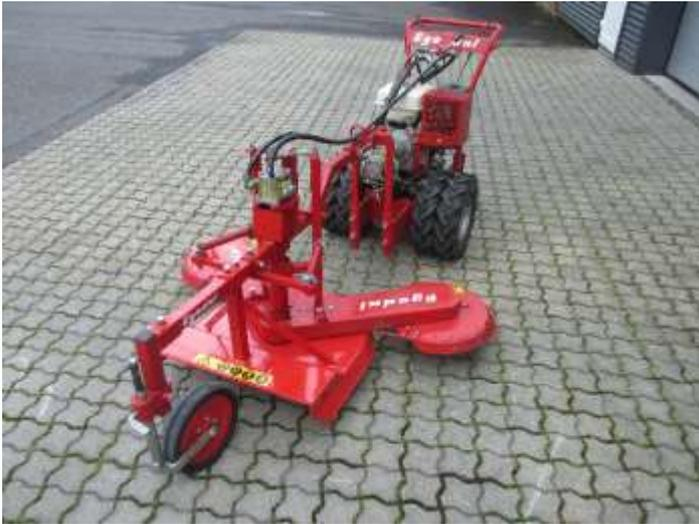
**Combiné mulcheur** central 60cm et 2 satellites de Ø40 montés sur bras escamotables par ressort
