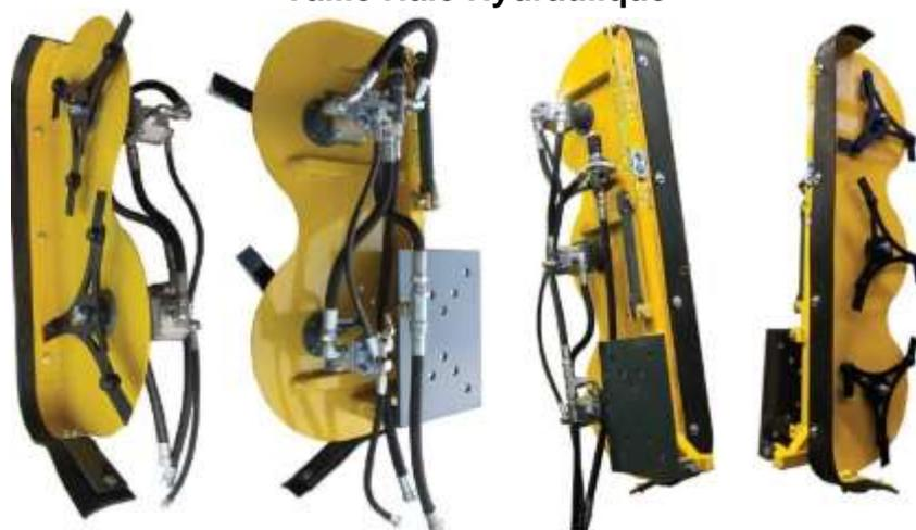
Taille haie type girobroyeur – chaque tête de coupe dispose de son propre moteur hydraulique
