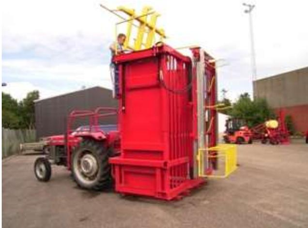
**Le palettiseur *Egedal*** est une machine nouvellement développée qui compacte les sapins de Noël sur palette afin d'en augmenter la capacité.
