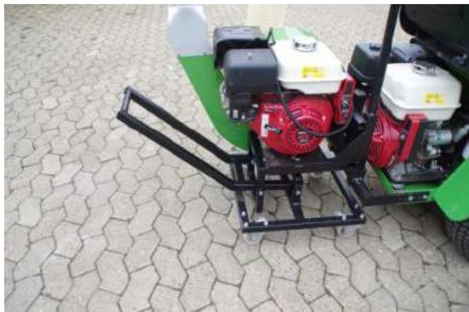
Moteur thermique entrainement turbine d'aspiration
