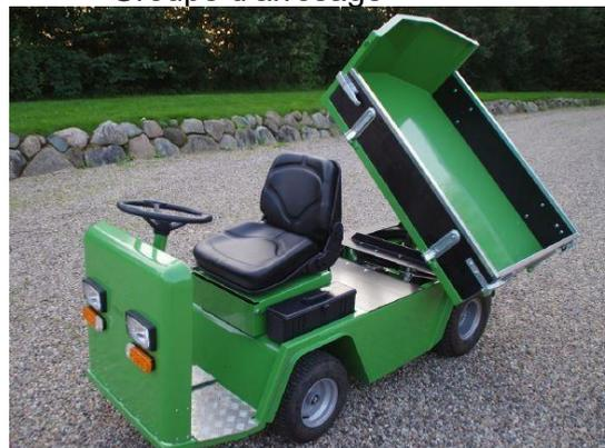
Benne basculante orientable
