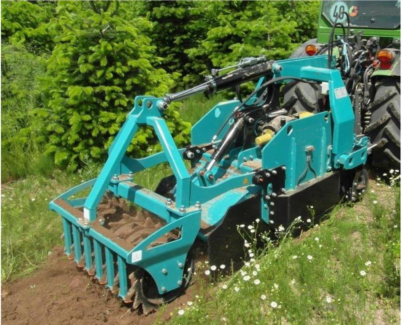
**BFC55 avec rouleau Packer et disques fendeurs de guidage**
