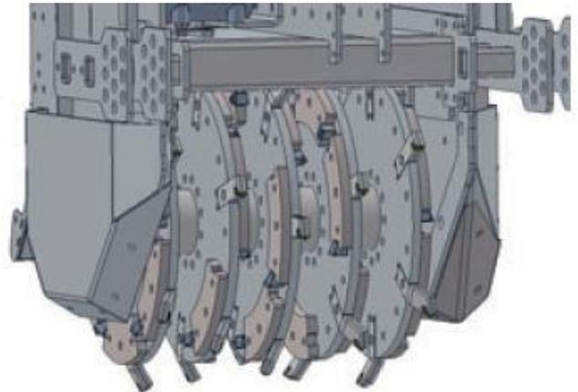
La machine peut se transformer en fraiseuse de grande souche en démontant le rotor à couteaux et en le remplaçant par celui à dents fixes
