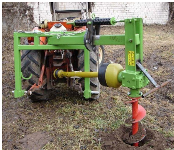
Tarière avec déport et vérin d'inclinaison
