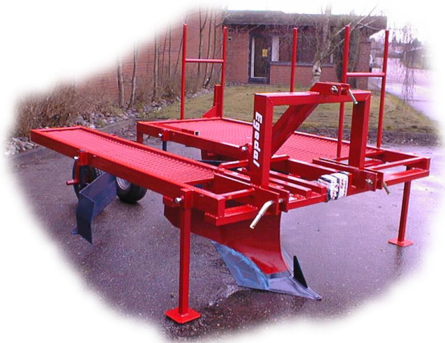
Cadre robuste et plaques de buttage réglables
