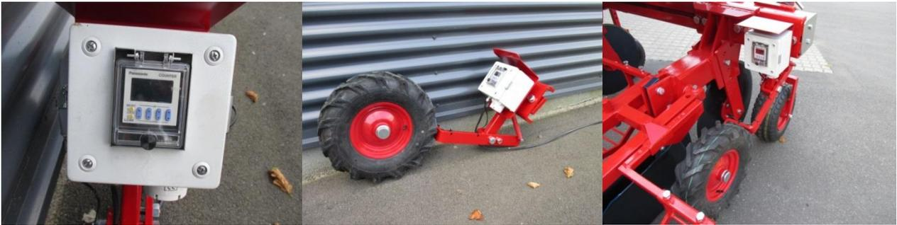
Un capteur calcule la distance parcourue et envoie un signal aux opérateurs pour la mise en place des plants.
