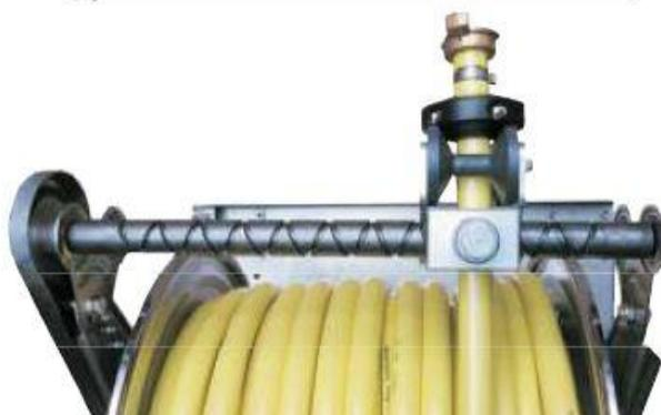
Guide d'enroulement par vis sans fin
