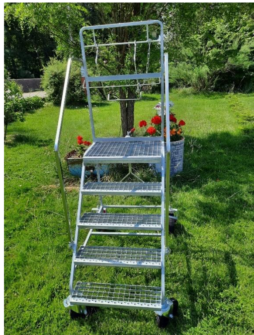
MECR1051 - 2 Roues mobiles et 2 roues fixes – 1 frein de blocage 4 marches – plateforme caillebotis env. 56x35cm – hauteur au sol env. 87cm Support pour caisse 60x40cm
