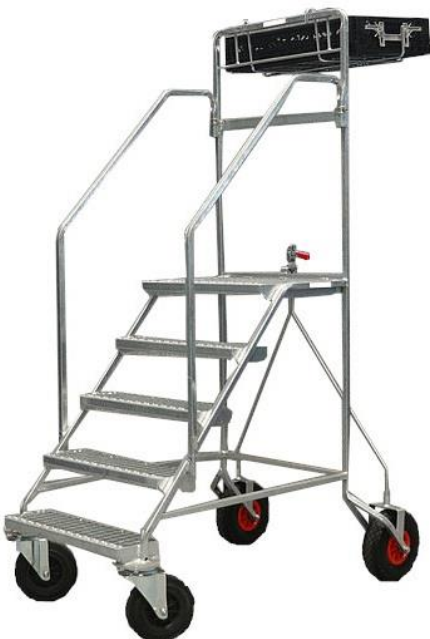
MECR1051 - 2 Roues mobiles et 2 roues fixes – 1 frein de blocage 4 marches – plateforme caillebotis env. 56x35cm – hauteur au sol env. 87cm Support pour caisse 60x40cm
