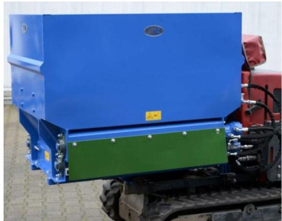
L'épandeur à compost dispose d'un attelage 3-points et permet de réaliser un apport précis directement au pied des cultures grâce à la sortie latérale. Il est réversible et peut également être utilisé pour déposer le compost dans le rang, la sortie se fait alors par l'arrière.
