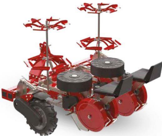
Opérateurs assis dans le sens de la marche pour sol lourd type TCT
