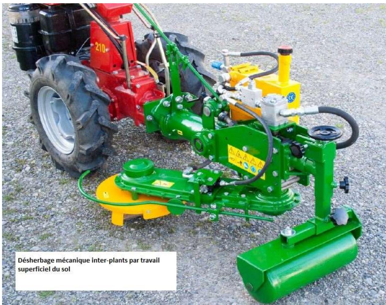
Outil Intercep mécanique avec palpeur hydraulique adaptable sur porteur monoaxe type motoculteur pour le travail du sol et le désherbage dans les rangs étroits et sur le rang en pépinières, viticulture, arboriculture, production de sapins de Noel, etc.
