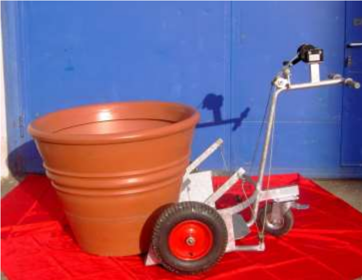
Chariot à plateau inclinable manuellement par treuil
