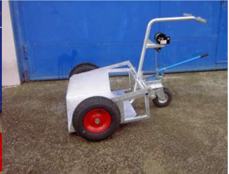
Chariot à plateau inclinable par vérin + treuil
