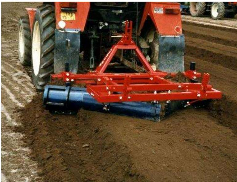
Le **Buttoir *EGEDAL*** est un équipement robuste qui lève la planche, la forme et assure la planéité jusqu'à une hauteur de 200 mm. Idéale pour les cultures à dos.
