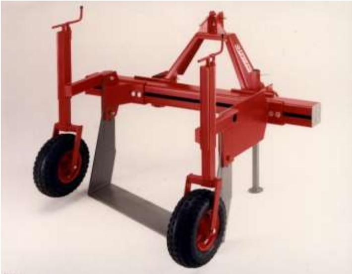
La machine à cerner **EGEDAL** de type BRS est utilisée pour le cernage de planches complètes.
