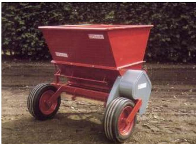
La machine est équipée d'une trémie en acier dans laquelle sont montés deux malaxeurs qui distribuent le sable vers un cylindre. Des tiges à bout rond sont soudées en spirale sur ce dernier pour garantir un épandage parfait du sable. Cet équipement est particulièrement performant et il est possible de régler précisément la quantité de sable à épandre.
