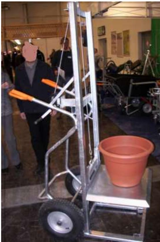
Equipé d'un treuil permettant de lever une charge de 200kg max. jusqu'à 150cm de hauteur
