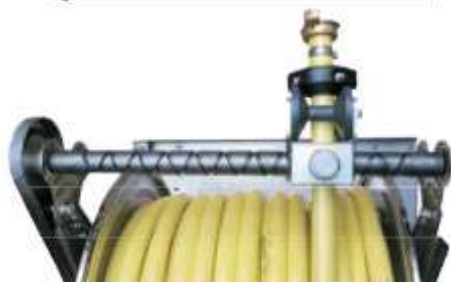
Guide d'enroulement par vis sans fin
