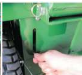
Désaccouplement du moteur électrique
